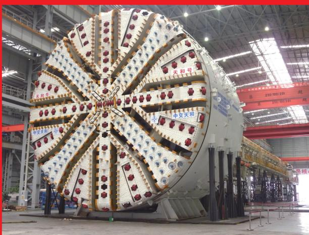
隧道掘进设备设计、制造、施工技术达到国际领先水平。“天和号”是中国研制的最大、直径达 15.03 米的泥水气压平衡复合式隧道掘进机。
